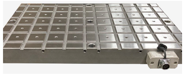
Onarım sonrası yüzeyi yeniden taşlanmış tabla · Chuck with re-ground pole face after repair
